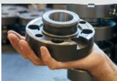
**Sistema bloccaggio utensili.** Il portautensili TG2000 è dotato di un attacco studiato, progettato e brevettato da Trevisan. La base di appoggio dell'attacco è molto ampia, e questa caratteristica sommata ad un ottimo bloccaggio, determina una rigidità assoluta tra utensile e carrello di tornitura.
